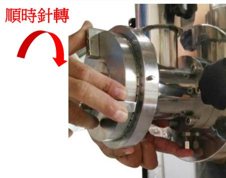
一隻手將螺桿固定銷往上頂住，一隻手將旋轉磨盤順時鐘方向轉緊，裝回前蓋，鎖上前蓋旋鈕即可。
