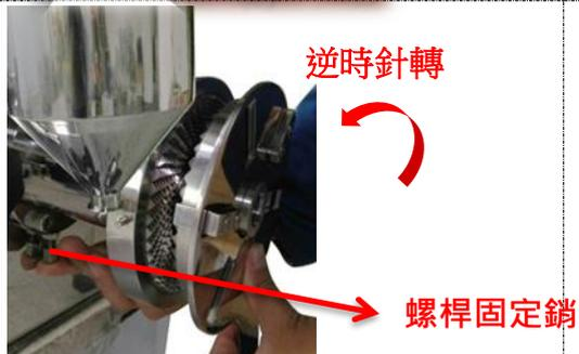
一隻手將螺桿固定銷往上頂住，一隻手用旋轉磨盤扳手將旋轉磨盤逆時鐘轉出，將扳手放下並以雙手將磨盤轉出，以免磨盤掉到地上。
