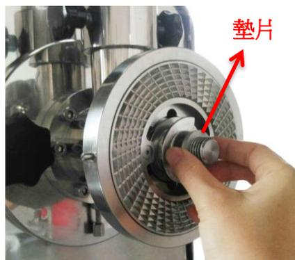
選擇厚度適合之墊片，於安裝磨盤前，套入不繡鋼螺桿螺紋內。
